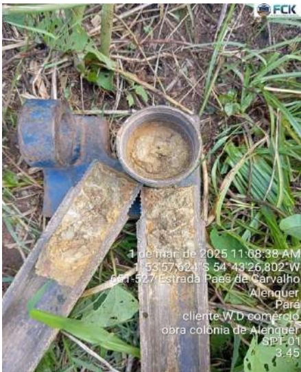
IMAGEM 4: AMOSTRADOR - PADRÃO COM SOLO DE 3,45m
