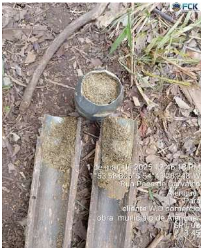
IMAGEM 4: AMOSTRADOR - PADRÃO COM SOLO DE 3,45m
