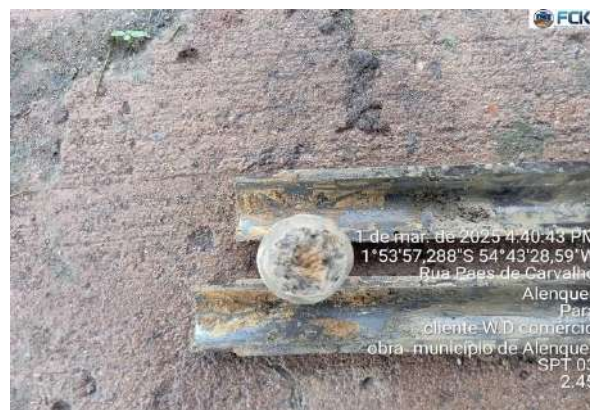
IMAGEM 4: AMOSTRADOR - PADRÃO COM SOLO DE 2,45m
