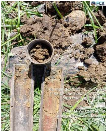
IMAGEM 4: AMOSTRADOR - PADRÃO COM SOLO DE 1,45m
