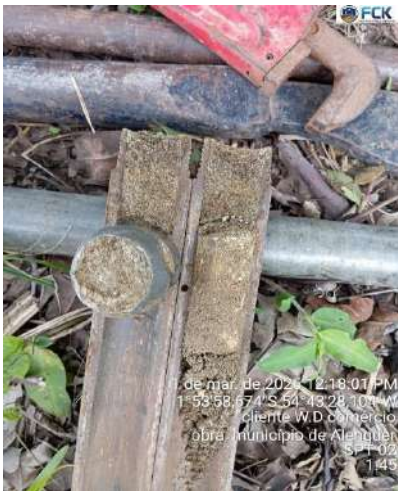
IMAGEM 4: AMOSTRADOR - PADRÃO COM SOLO DE 1,45m
