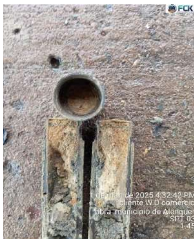
IMAGEM 4: AMOSTRADOR - PADRÃO COM SOLO DE 1,45m
