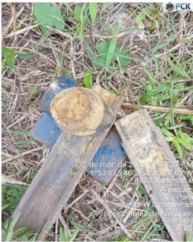
IMAGEM 4: AMOSTRADOR - PADRÃO COM SOLO DE 4,45m
