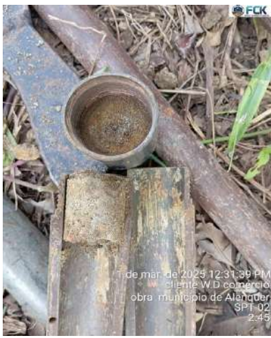
IMAGEM 4: AMOSTRADOR - PADRÃO COM SOLO DE 2,45m
